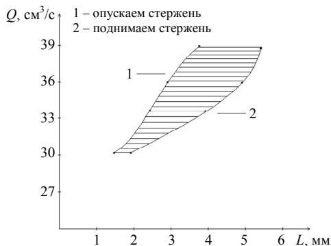
Рис. 2. Область существования РВОП в координатах расход воздуха – расстояние от стержня до среза трубки в случае опускания стержня и его подъема. Диаметр горелки 7 мм, диаметр стержня 4 мм
