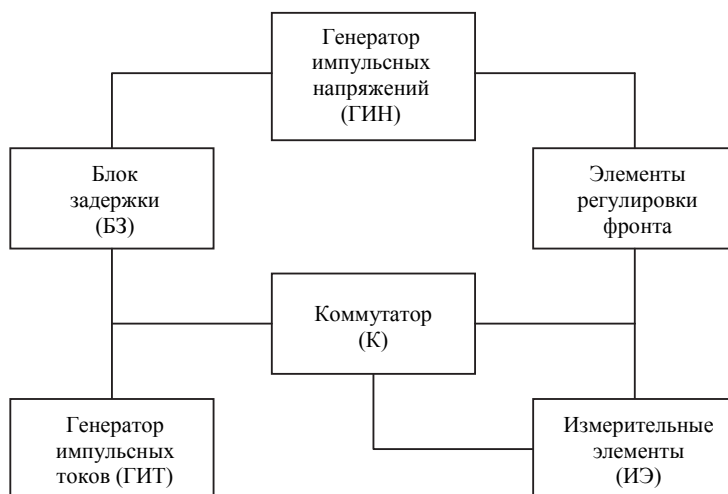
Рис. 1. Структурная схема экспериментальной установки для измерения ВЭП
