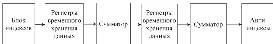
Рис. 3. Схема одного канала БПФ-СОК с индексированием данных
