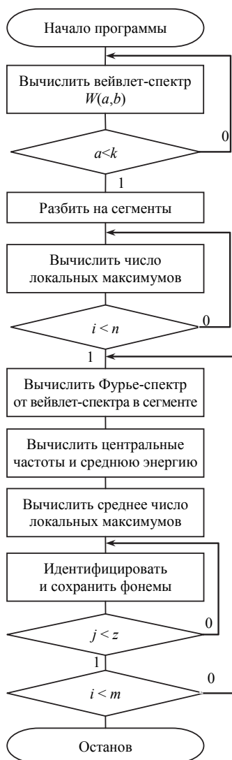
Рис. 2. Блок-схема алгоритма идентификации фонем
