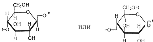
Рис. 1. Фрагменты макромолекулы целлюлозы
